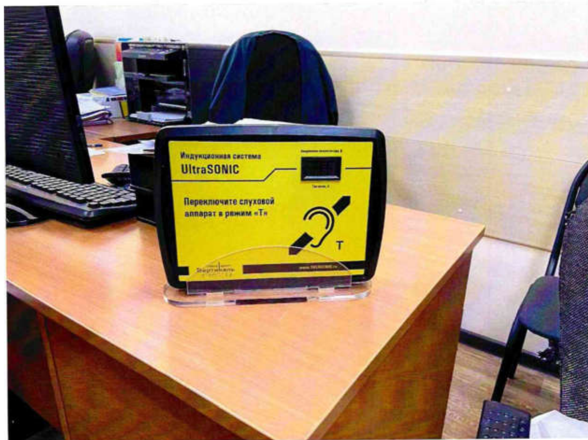
Рисунок 6.9. Переносная портативная индукционная система для слабослышащих посетителей
